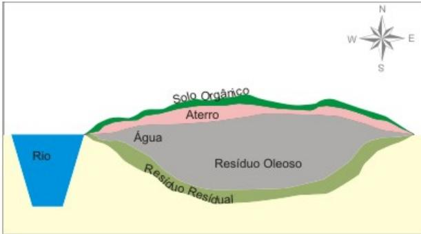
**Figura 5.** Modelo da cava, construído com os resultados geofísicos, complementados peãs amostras de solo.
